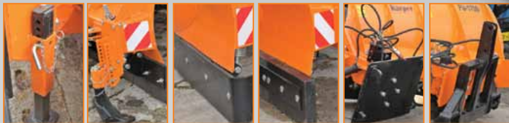
опора скользуны металлический нож из стали HARDOX резиновый нож система подвески EURO SMS TCH
