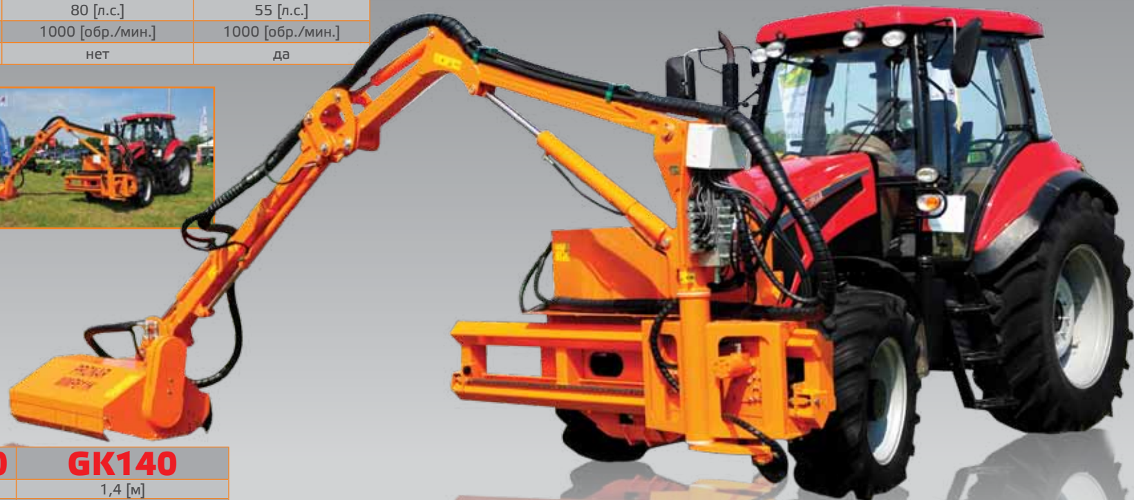
Стрела универсальная PRONAR WWP600 i WWP400 работает с головками PRONAR GM500, GO800, GP200
